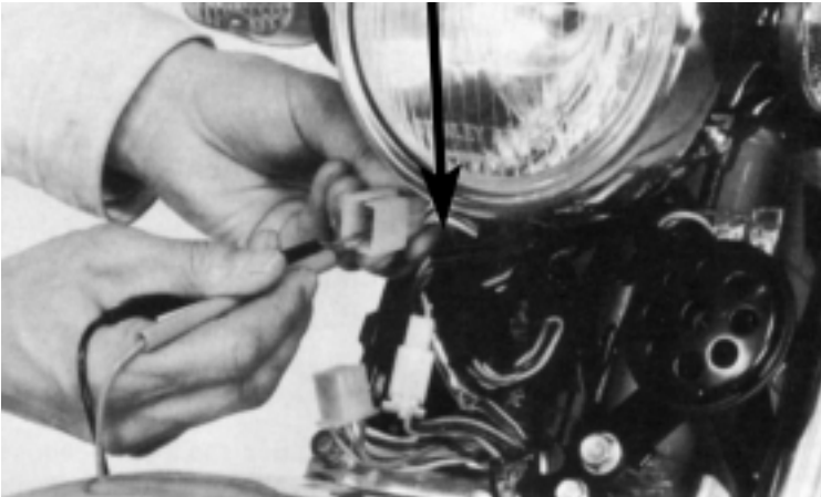
FIAÇÃO DO INTERRUPTOR DE IGNIÇÃO
